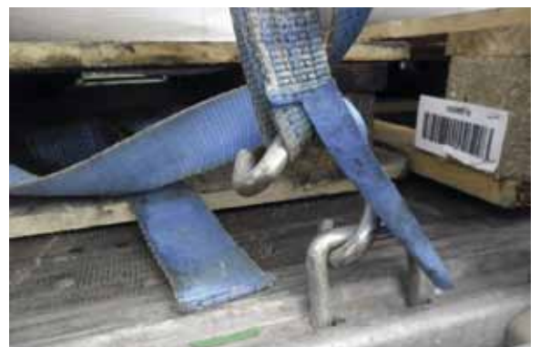
Niet correct aangebrachte spanriem
