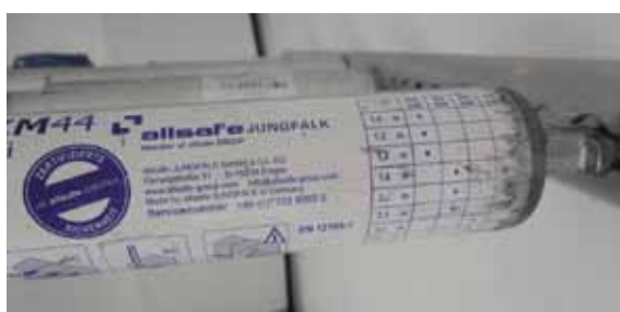
Stang met aangeduide waarden voor tegenkracht
